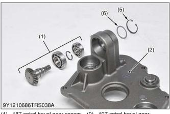
18T spiral bevel gear assem- (9) 19T spiral bevel gear (1)
